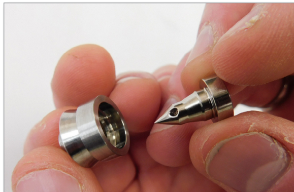
Abbildung 19-23 Installation des Torpedos
