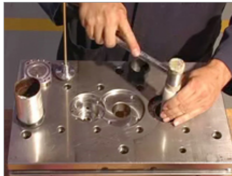
Abbildung 10-18 Installation des Zylinders
