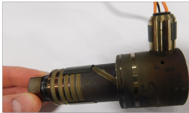
Abbildung 19-16 Installation der oberen Hälfte des Melt Transfer-Links
