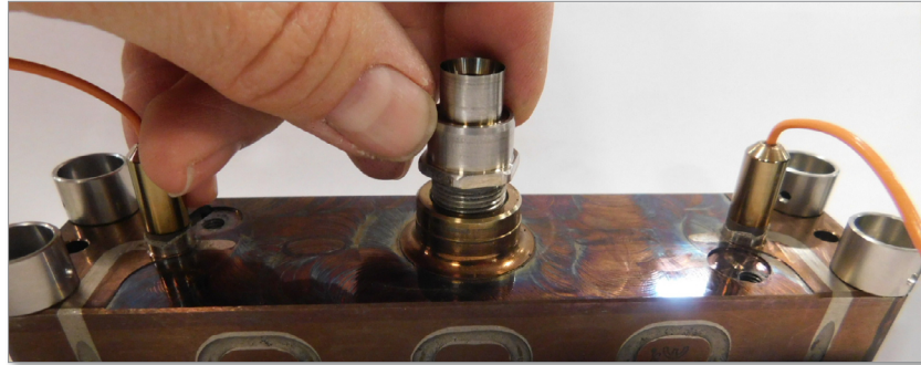
Abbildung 19-15 Installation der unteren Hälfte des Melt Transfer-Links
