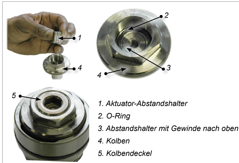
Abbildung 10-19 Installation des Kolben-Abstandshalters
