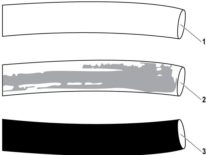
Figura 11-1 Comparación de líneas de refrigeración limpias y contaminadas
