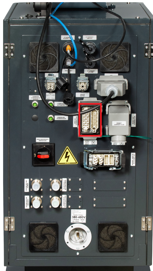
Figura 5-6 Conector IMM E67 en la parte posterior del controlador
