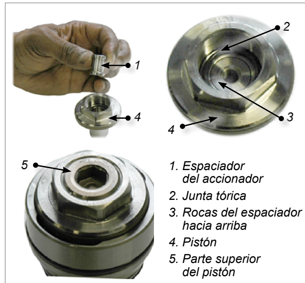
Figura 10-19 Instalación del espaciador del pistón
