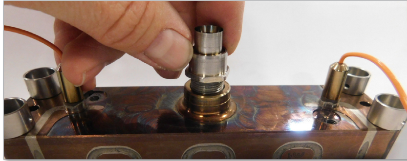
Figura 19-15 Instalación de la mitad inferior de la conexión de transferencia de colada
