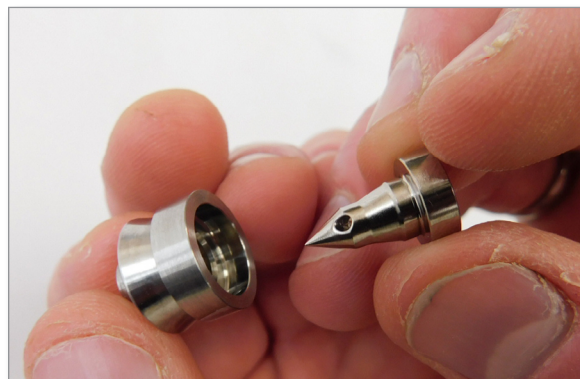
Figura 19-23 Instalación del torpedo
