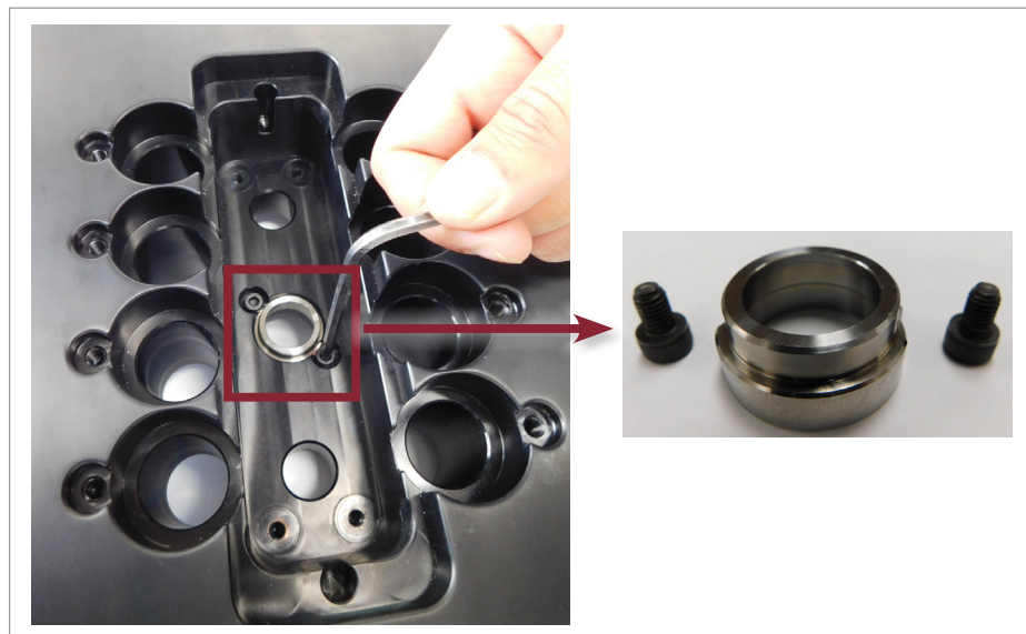
Figura 19-18 Instalación del localizador de centro
