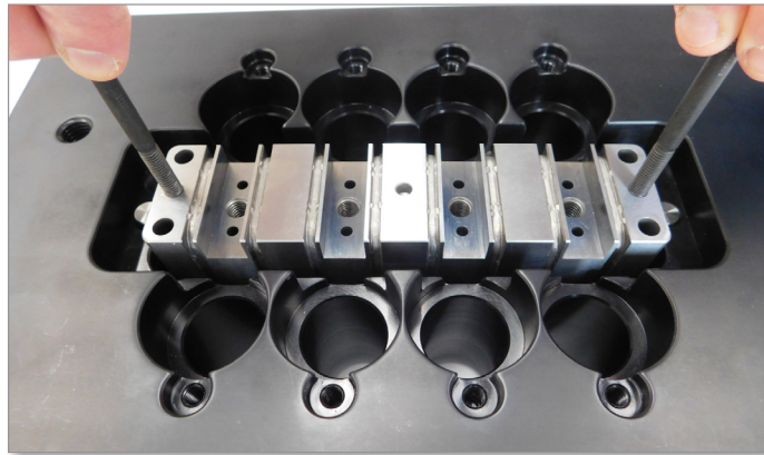
Figura 19-20 Instalación del colector de Melt-CUBE
