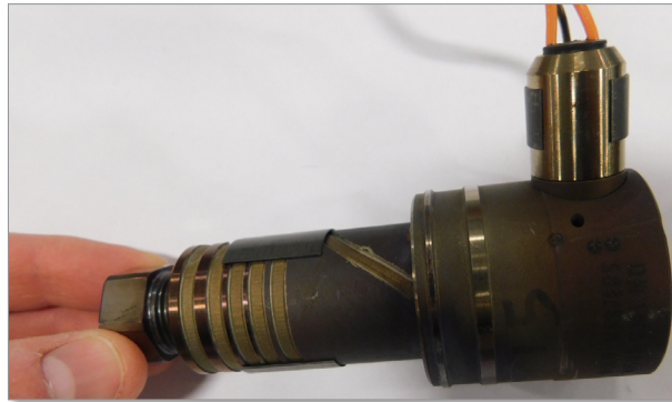
Figura 19-16 Instalación de la mitad superior de la conexión de transferencia de colada
