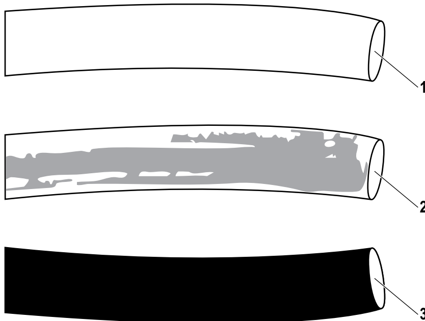
Figure 11-1 Comparaison des conduites de refroidissement propres et contaminées
