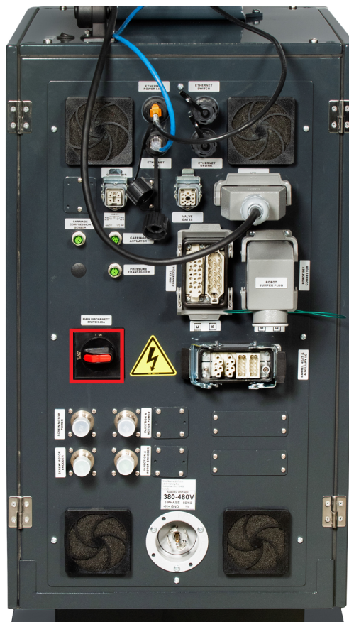
Figura 6-1 Interruttore di alimentazione principale
