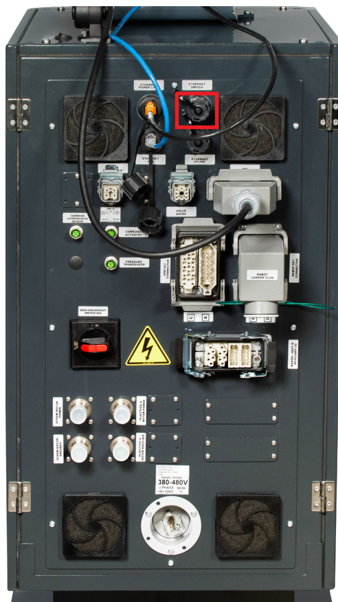
Figura 5-7 Collegamenti del touchscreen
