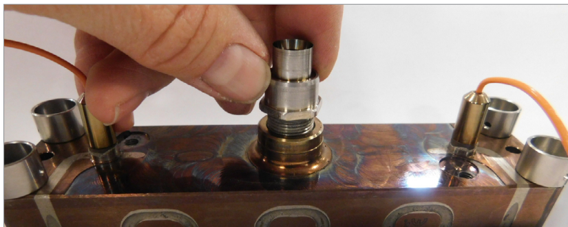
Figura 19-15 Installazione della metà inferiore del collegamento di trasferimento fusione
