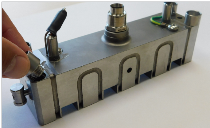
Figura 19-19 Installazione delle bocche
