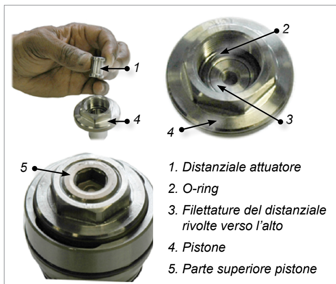
Figura 10-19 Installazione del distanziale del pistone
