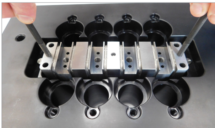
Figura 19-20 Installazione del collettore del Melt-CUBE
