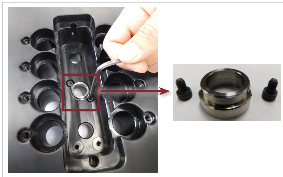
Figura 19-18 Installazione del posizionatore centrale
