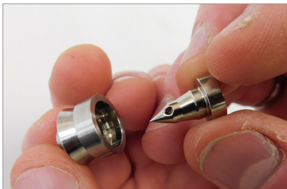
Figura 19-23 Installazione del torpedo
