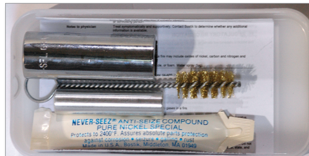
Figura 15-10 Utensili per la tenuta della saracinesca Sprint
