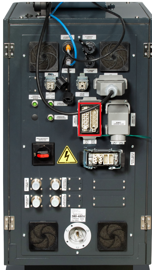
Figure 5-6 Formsprutningsmaskin E67-kontakt på baksidan av styrenheten
