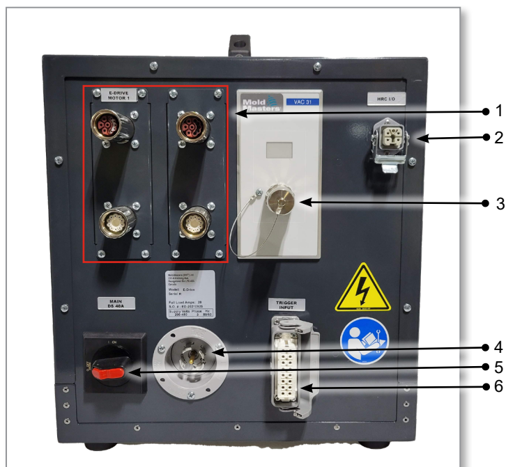
Figure 7-1 Anschlüsse des E-Drive Schaltschranks
