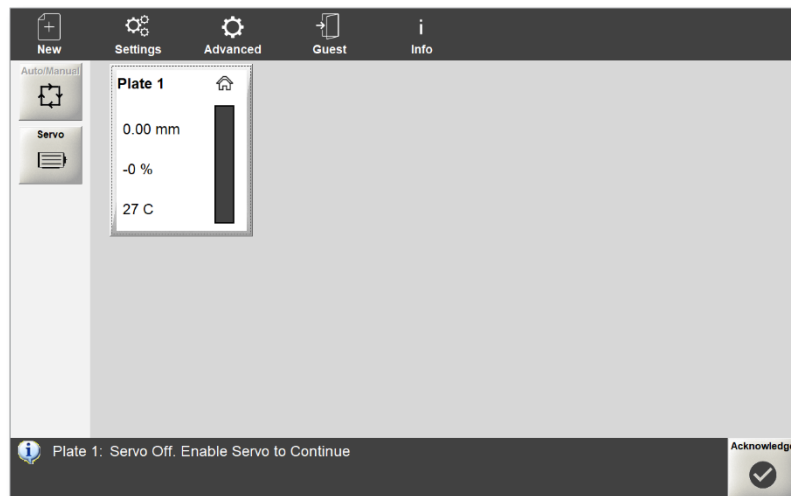
Figure 7-2 Hauptbildschirm der E-Drive-Steuerung
