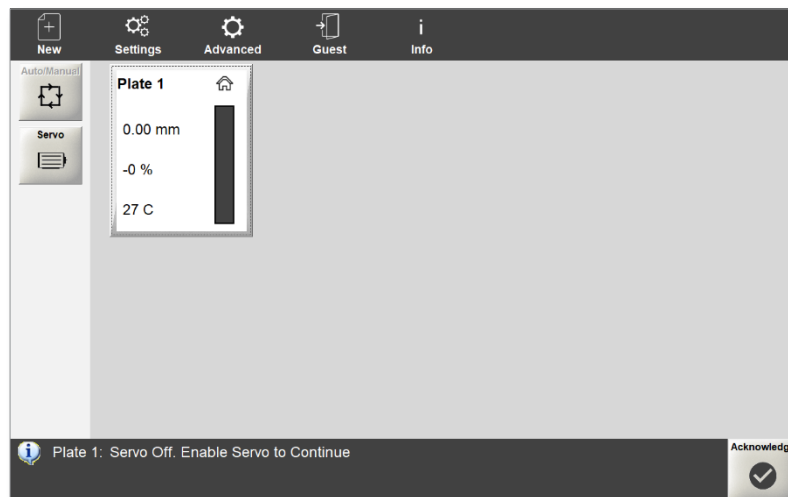
Figura 4-2 Schermata principale del controller E-Drive
