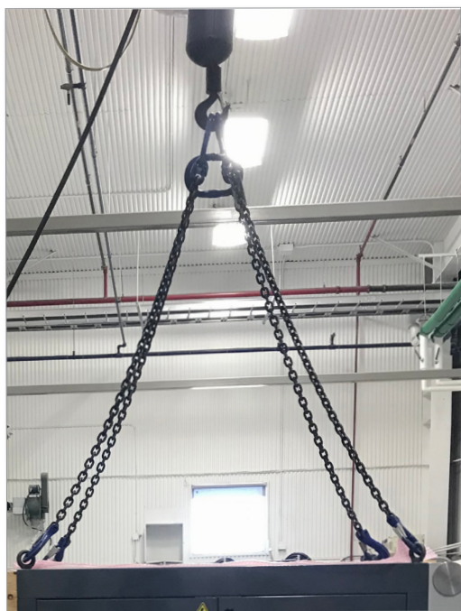
Rysunek 3-11 Zamocować zawiesia do wszystkich czterech śrub oczkowych
