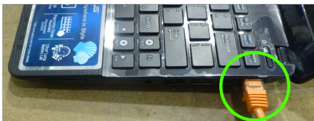
图 5-7 诊断计算机上的以太网端口
