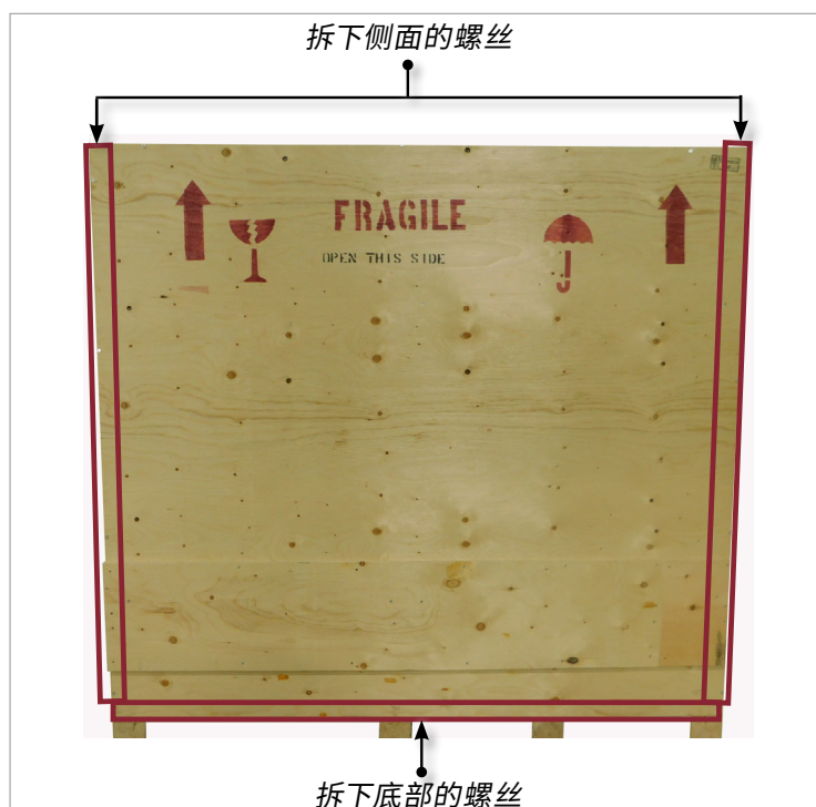
图 3-8 拆下侧面和底部的螺丝
