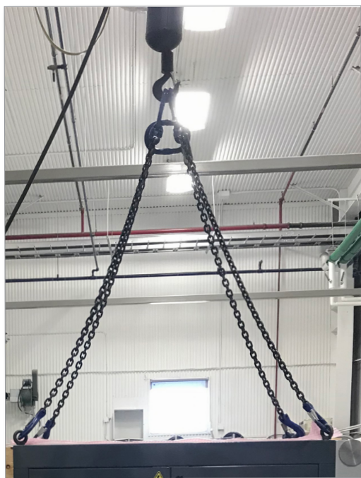
图 3-11 将吊索连接到所有四个吊环螺栓上
