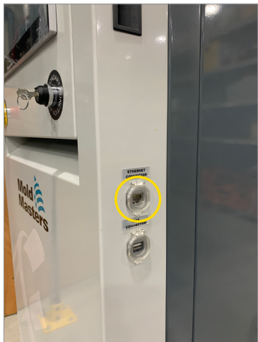
图 5-6 控制器上的以太网端口
