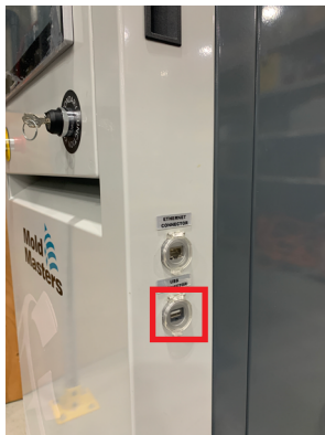
图 10-11 控制器侧的 USB 连接
