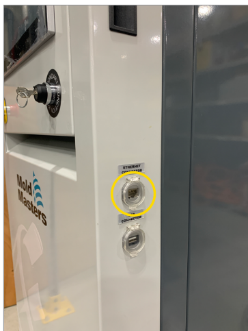
Figura 5-6 Puerto Ethernet en el controlador
