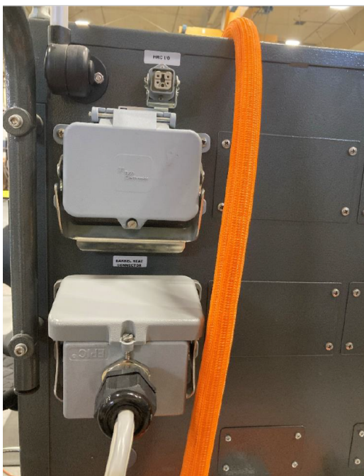
Figura 8-40 Vista trasera de controlador con conector de calefactores del cilindro
