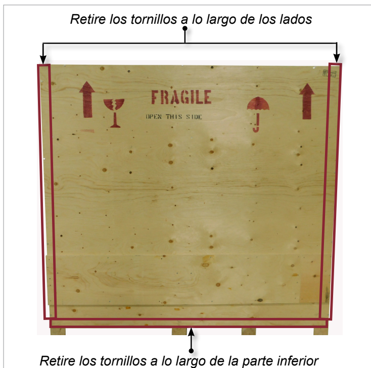
Figure 3-8 Retire los tornillos de los lados y la parte inferior
