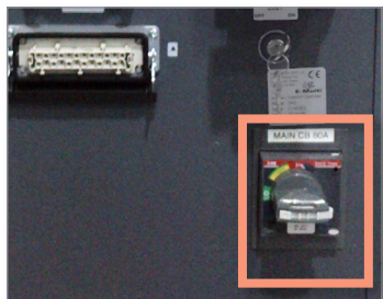
Figure 6-1 Interruptor de alimentación principal E-Multi
