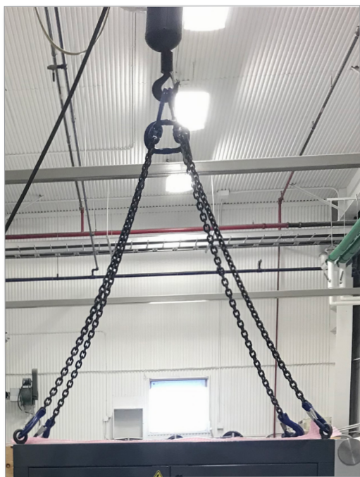
Illustration 3-11 Fixez les élingues aux quatre boulons à œil
