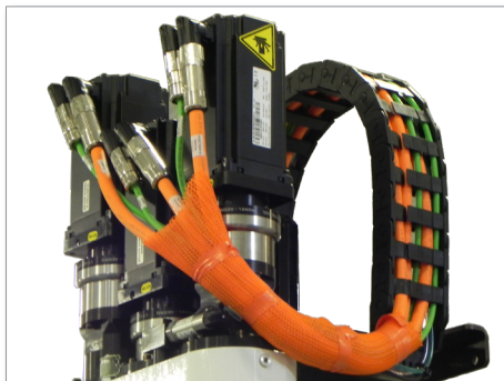
Illustration 5-1 Acheminement des câbles servo EM3
