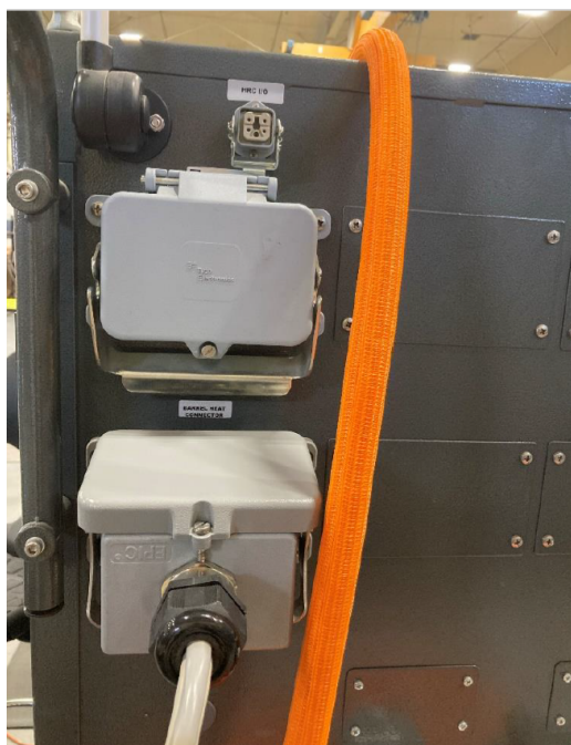
Illustration 8-40 Partie arrière du contrôleur avec connecteur de l'élément chauffant des cylindres
