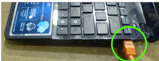
Figura 5-7 Porta Ethernet del computer diagnostico
