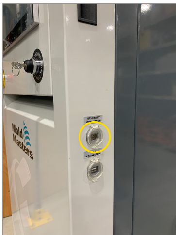
Figura 5-6 Porta Ethernet del controllore
