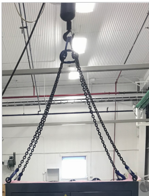
Figura 3-11 Fissare le imbracature a tutti e quattro i bulloni a occhio
