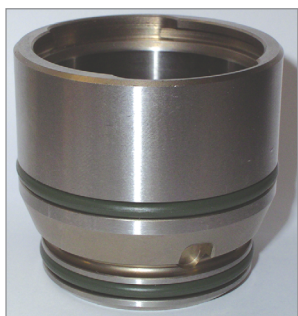
Abbildung 5-37 O-Ringe für den unteren Zylinder der Serien 6X00 und 7100
