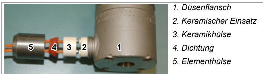
Abbildung 10-6 Düsenklemmenbaugruppe
