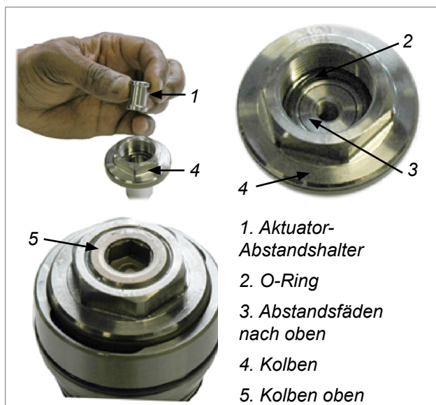
Abbildung 5-52 Montage des Kolbenabstandshalters
