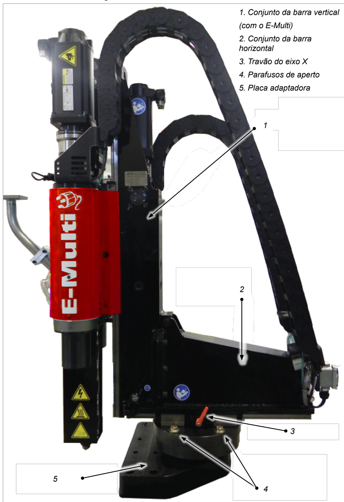
Figura 12-1 Componentes principais do E-Multi Radial
