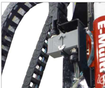
Figura 12-1 Instalar o conector de aquecimento de cilindros
