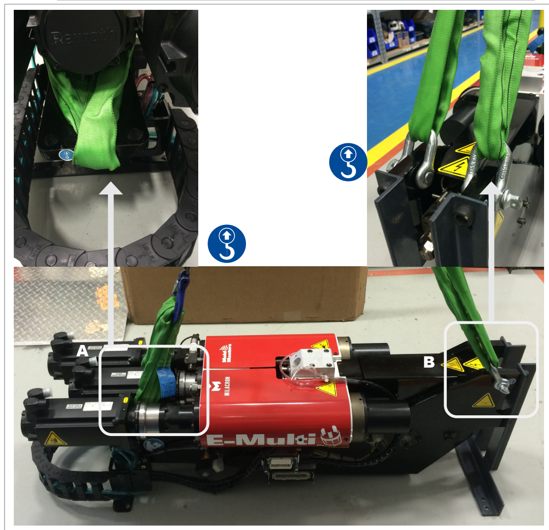
Figura 3-7 Ligações elevatórias horizontais EM3 Semelhante a EM1/EM2
