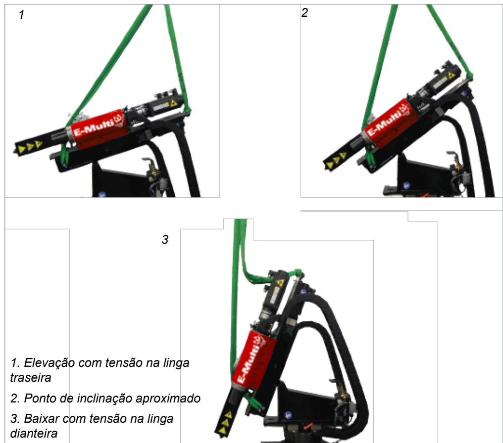
Figura 12-6 Inclinar o E-Multi Radial da posição horizontal para a vertical
