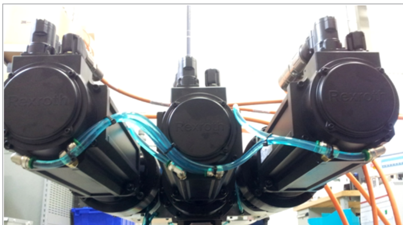
Figura 7-8 Ligações de refrigeração do servomotor EM3/EM4
