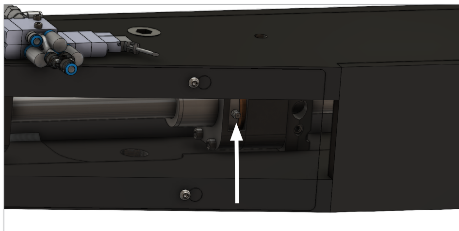
Figura 9-12 Vista inferior que mostra a localização do ponto de lubrificação da porca do fuso de esferas do carro (sistemas pré-meados de 2023)
