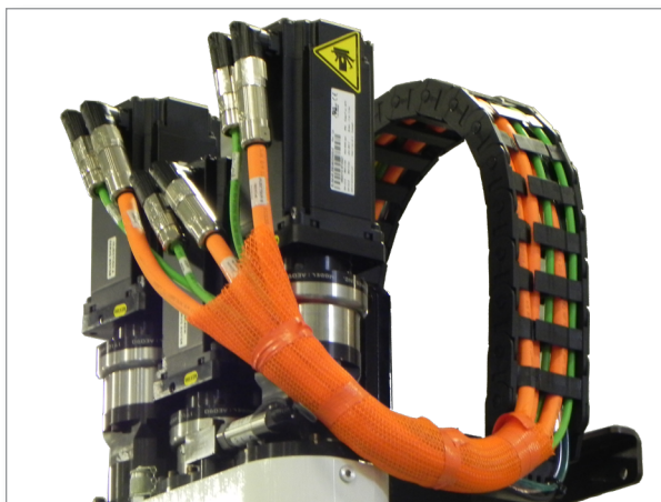
Figura 7-1 Encaminhamento de cabos do servomotor EM3
