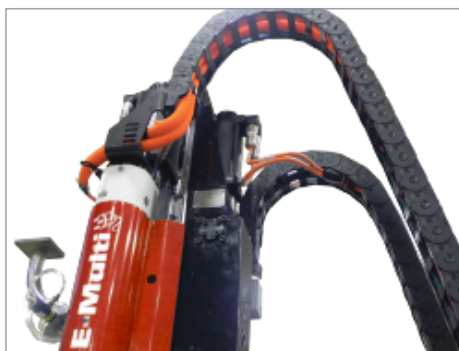
Figura 12-2 Fixe os cabos do servomotor
